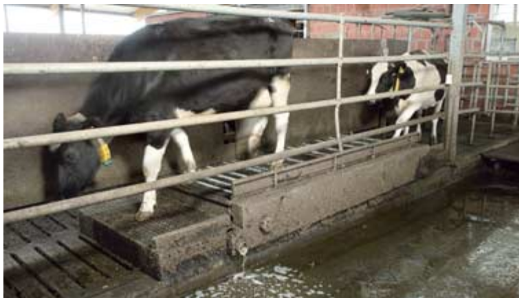
Der Klauenreiniger kann auch in vorhandene Anlagen im Ausgangsbereich des Melkstands integriert werden. Mit Podest wird eine Länge von 4 m benötigt.
