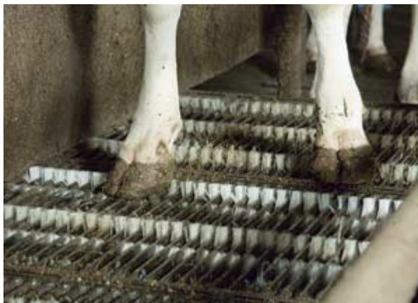
Der Borstenüberstand ist einstellbar. Bei Höhen um die 1,5 cm sind Hautverletzungen äußerst unwahrscheinlich.
