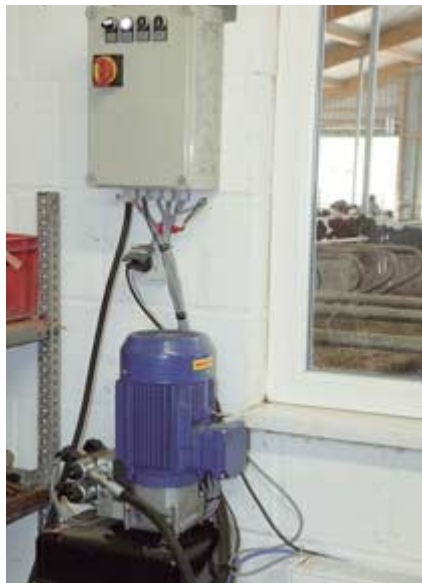
Als Antrieb für die Maschine dient ein Hydraulikaggregat mit 3-kW-Elektromotor. Die Steuerung im Kasten darüber übernimmt das automatische Ein- und Ausschalten.
