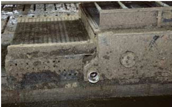
Ein Kratzboden in der Wanne räumt den Dreck zur Austragschnecke. Bei Bedarf kann der Schmutz separat von der Gülle abgeleitet werden.
